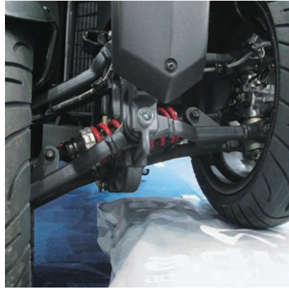
右はジュネーブショーで発表されたトヨタのコンセプト3輪EV、i-ROAD。リヤをアクチュエーターで操作することで車体をバンク・旋回させる。左はイタリアAdiva社のコンセプト3輪“ADtre”。フロントは2輪でダブルウィッシュボーンに似た形式を採用しているが、中央をスプリングで結んだモノショック式が特徴的。
