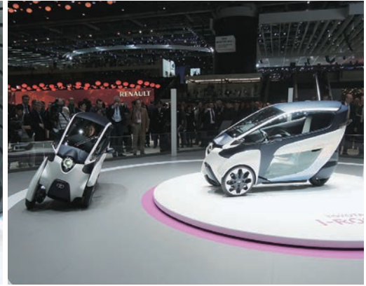
右はジュネーブショーで発表されたトヨタのコンセプト3輪EV、i-ROAD。リヤをアクチュエーターで操作することで車体をバンク・旋回させる。左はイタリアAdiva社のコンセプト3輪“ADtre”。フロントは2輪でダブルウィッシュボーンに似た形式を採用しているが、中央をスプリングで結んだモノショック式が特徴的。
